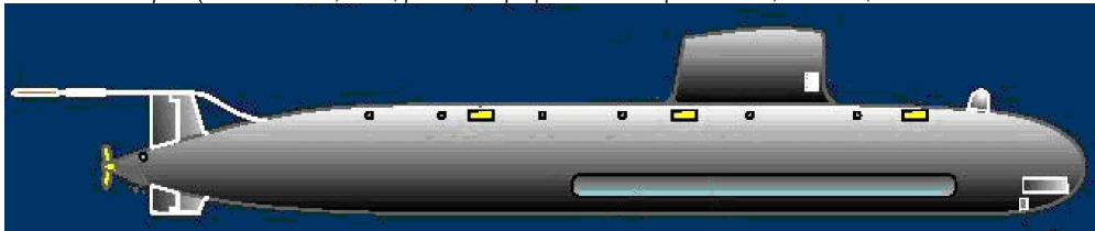
arquitectura sonar del S80 plus (firmada Bazán, 2017; previa a superponer las tres placas PRS, amarillas, sobre la banda lineal del FAS, azul)
